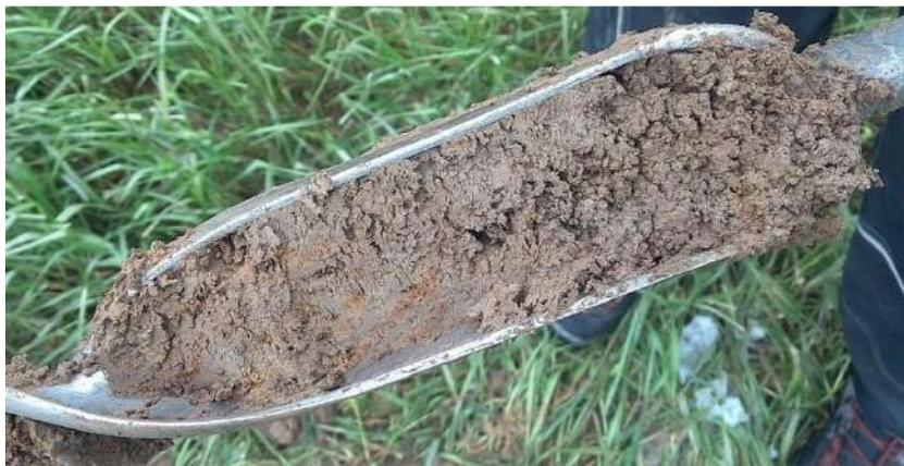
Figure 25 : Exemple de sol rédoxique observé sur le terrain
