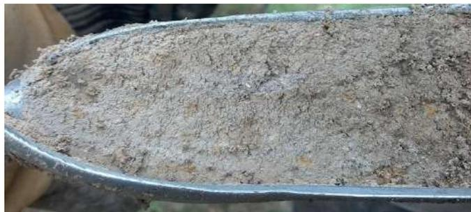
Figure 25 : Exemple de sol rédoxique observé sur le terrain
