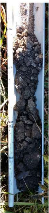
Restitution du profil de sol du sondage 3
