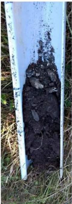
Restitution du profil de sol du sondage 2
