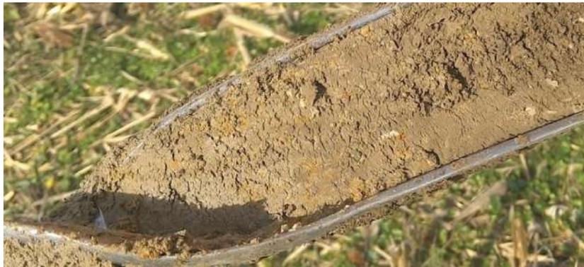
Figure 25 : Exemple de traits d'hydromorphie (taches de rouille) observés sur la commune
