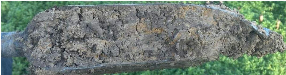
Figure 25 : Exemple de trait d'hydromorphie observé sur la commune (taches de rouille)
