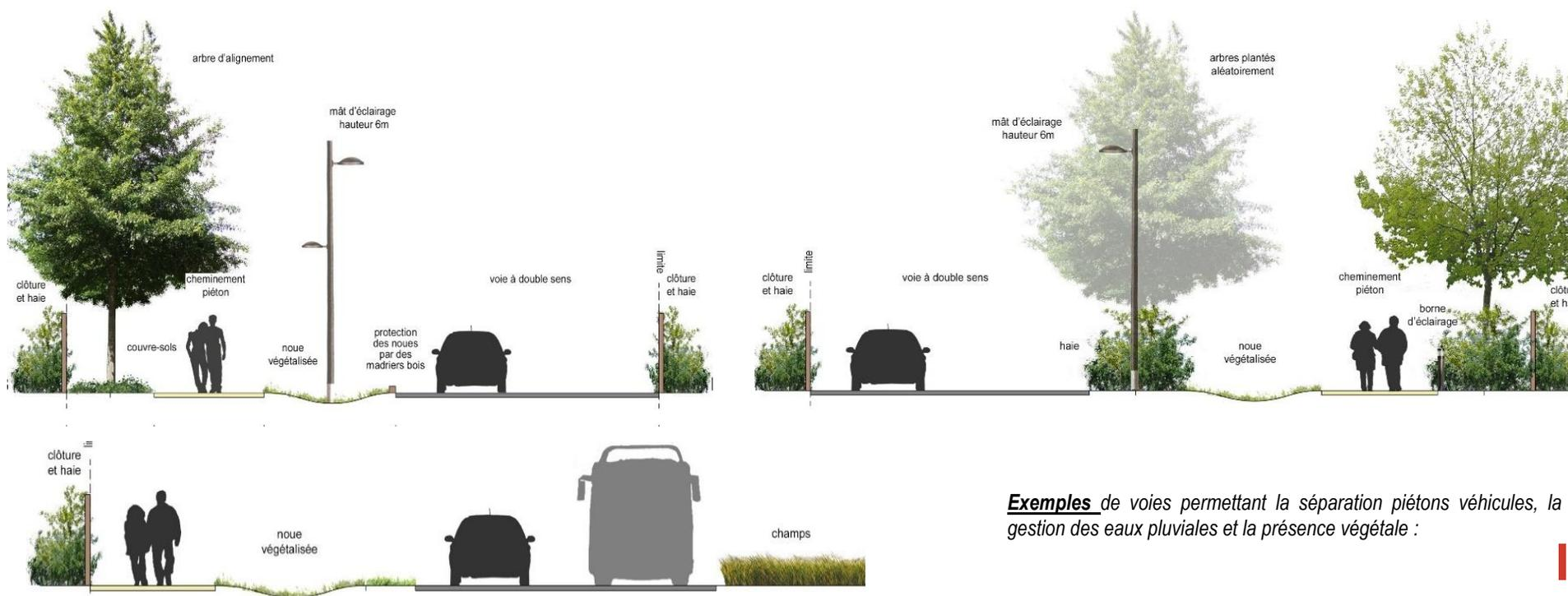
**Exemples** de voies permettant la séparation piétons véhicules, la gestion des eaux pluviales et la présence végétale :
