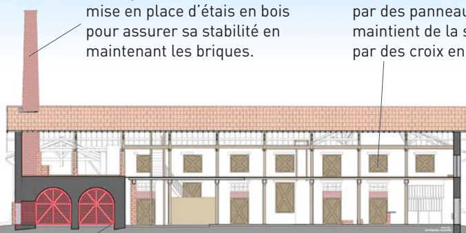
Dépose de la partie haute de la cheminée du four Hoffmann pour éviter tout risque d'effondrement
